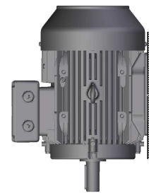
IM V5 IM 1011 vertical foot wall mounted shaft down
