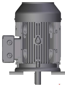
IM V1 IM 3011 flange at DE shaft down no feet
